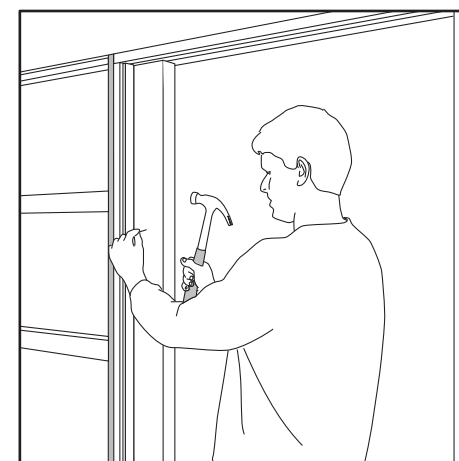
16 Spika fast täcklisterna. Søm dæklisterne fast. Stift fast dekklistene. 3–4 mm avstånd.
